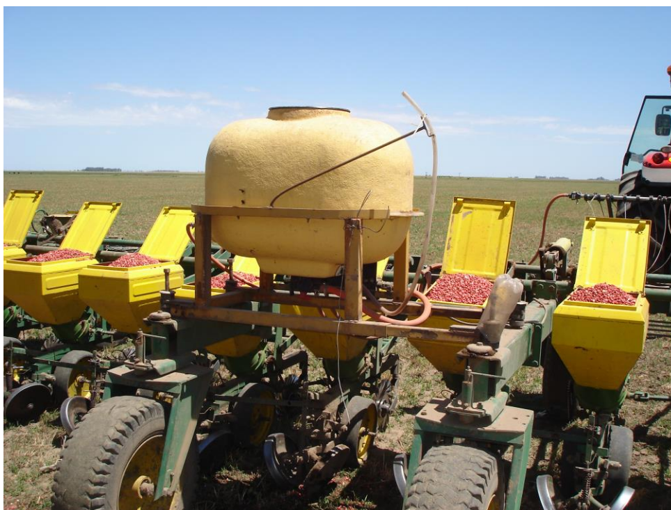
Figura N°1: “Kit” inoculador instalado en sembradora, durante siembra de maní
