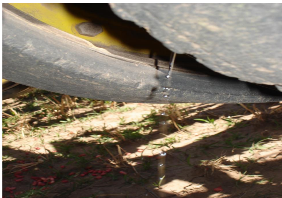
Figura N°2: Caldo de inoculante aplicado en el surco de siembra, (la sembradora esta levantada para la observación del mecanismo)
